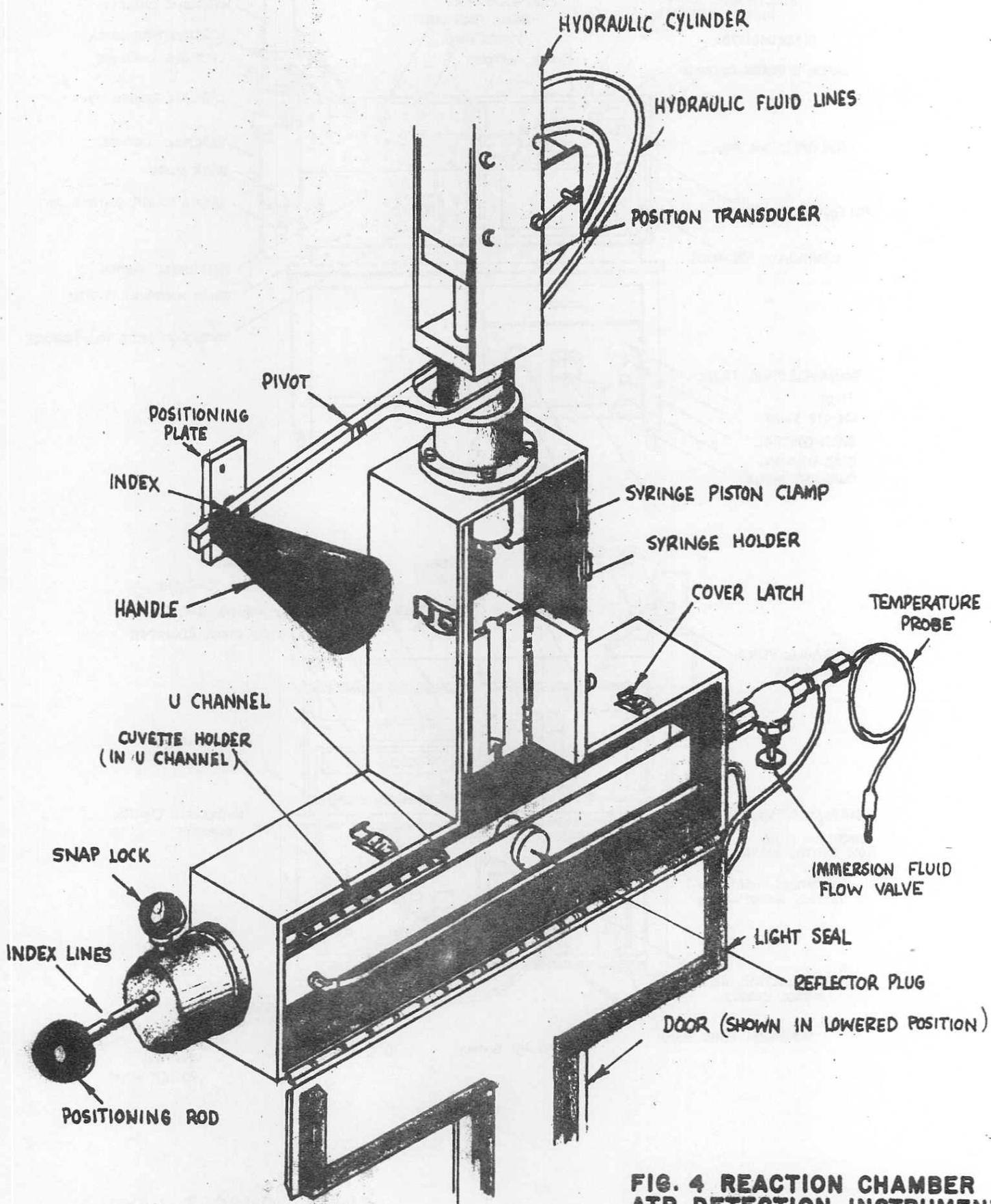
**FIG. 4 REACTION CHAMBER
